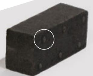
Das Formbackklinkersortiment wird mit Abstandhaltern geliefert. Diese sorgen für attraktive, gerade Linien im Pflaster mit einer Fugenbreite von ca. 3 mm. Die Abstandhalter bieten den zusätzlichen Vorteil, dass sie die Wasserdurchlässigkeit erhöhen. Die Kombination mit einem wasserdurchlässigen Fugenmörtel verhindert das Unkrautwachstum.
